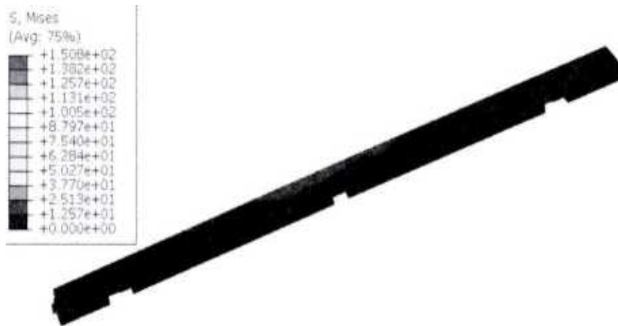
图 2 翻转梁结构仿真应力云图
